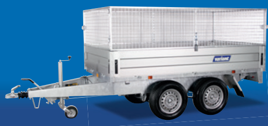
STANDARDAUSSTATTUNG Klappbare und abnehmbare Seiten. Eckpfosten können ohne Werkzeug entfernt werden.
