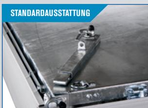
**Feuerverzinkter Stahlboden**, gefaltet und mit Verzurrösen. Abnehmbare Seiten.
