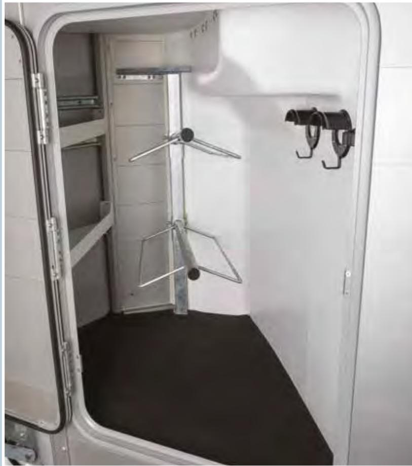
Bietet nützlichen Stauraum für die Ausrüstung und kann als Alternative zum Frontausstieg gewählt werden. Die Sattelkammer wird in den Vorderraum des Anhängers eingebaut und ist von aussen mit einer Seitentür zugänglich. Nur links erhältlich.
